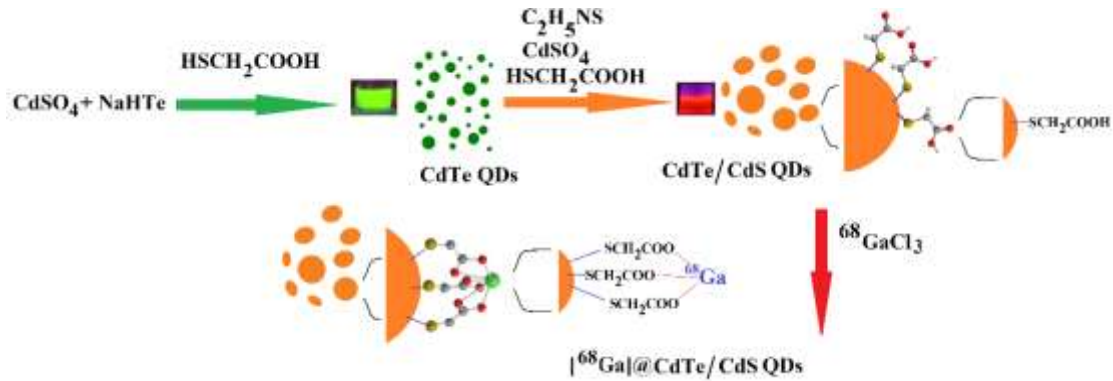
شکل ۲. مکانیسم تشکیل نانوذرات نشاندار
