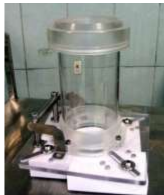
شکل شماره (۱): نمایی از اپلیکاتور Beam shaper (راست) و نحوه اتصال آن به سر شتابدهنده LIAC12 (چپ).
