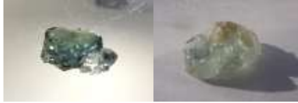
شکل ۴- بررسی تغییر رنگ سنگ بریل شماره ۱ به واسطه پرتودهی بیشتر، سمت راست: پرتودهی با دز حدود 1/5 \text{ MGy} - سمت
