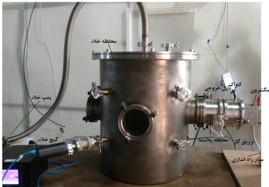
شکل ۴. چیدمان آزمایشگاهی تست چشمه پلاسما.
