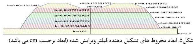
شکل ۵. ابعاد مخروطی‌های تشکیل دهنده فیلتر و برایش شده (ابعاد برحسب cm می‌باشد)
