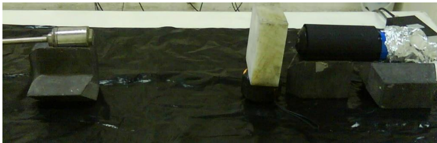
شکل ۴. چیدمان اندازه‌گیری نوترون گرمایی ناشی از نمونه گرافیت
