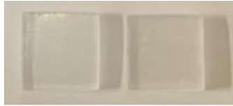
شکل ۱. تصاویر قطعات بلورهای CsI:Na مطالعه شده با ابعاد حدود 16 \times 16 \times 3/5 \text{ mm}^3 .
