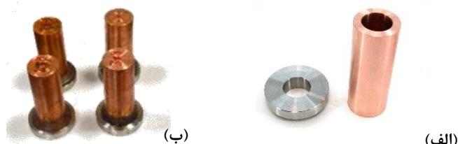
شکل ۲. الف) نمونه آماده‌سازی شده مس و استیل قبل از اتصال؛ ب) نمونه‌های اتصال داده شده مس به استیل با فرآیند جوش اصطکاکی.
