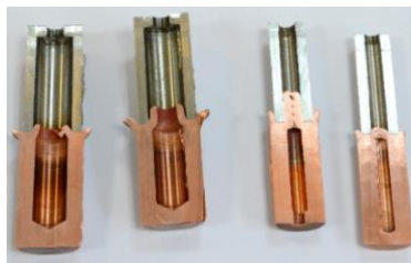
شکل ۴. نمونه‌های برش خورده جهت انجام تست‌های متالورژیکی.
