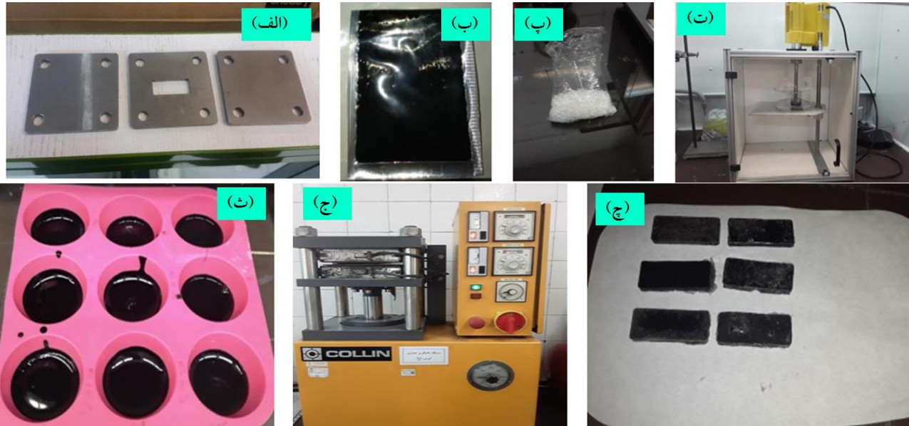
شکل ۱. نمایی از مراحل ساخت و آماده سازی نمونه های نانوکامپوزیت PS/MWCNT به عنوان ماده حساس دزیومتر، (الف) قالبهای فولادی دزیومتر، (ب) پودر نانولوله کربن چند دیواره، (پ) گرانول پلی استایرن، (ت) اولتراسونیک پروبدار برای پخش نانولوله کربن در بستر پلیمر، (ث) قالبهای سیلیکون، (ج) دستگاه پرس داغ و (چ) نمونه‌های نهایی نانوکامپوزیت ساخته شده.
