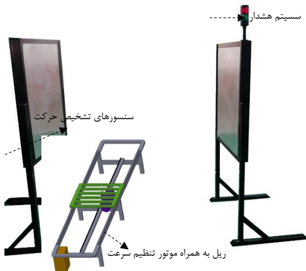
شکل ۳. شماتیکی از برپاسازی NSTRI-RPM-2020-1 در هنگام انجام آزمایش
