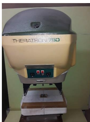
شکل ۵: سیستم پرتودهی استاندارد مرکز SSDL کرج و برد قرارگیری قطعات ماسفت
