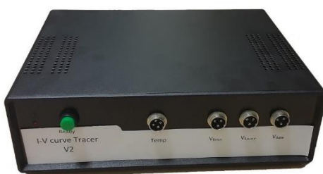
شکل ۴: نمای ظاهری دستگاه رسم کننده منحنی I-V ساخته شده
