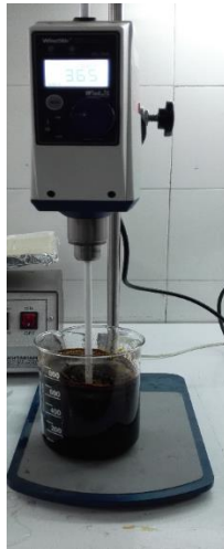
شکل ۱. شماتیک دستگاهوری سنتز نمونه اکسید آهن.
