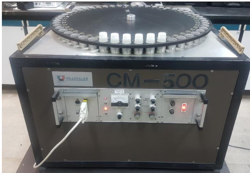
شکل ۲. دستگاه شمارشگر سوسوزن مایع CM-500 به همراه ویال‌های پلاستیکی حاوی محلول KCl.
