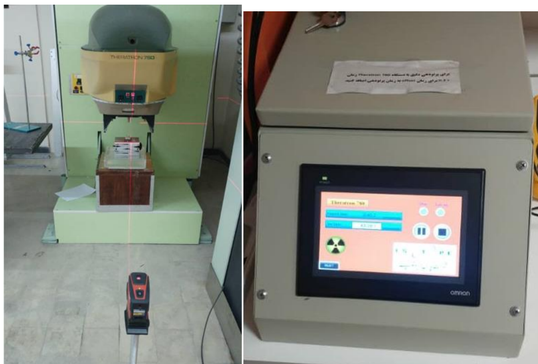
شکل ۳: سیستم پرتودهی آزمایشگاه دزیمتری استاندارد ثانویه کرج و برد قرارگیری قطعات ماسفت.
