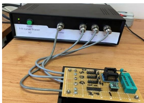
شکل ۲: نمای ظاهری دستگاه رسام منحنی جریان-ولتاژ ترانزیستورهای ماسفت ساخته شده در دانشگاه شهید بهشتی.
