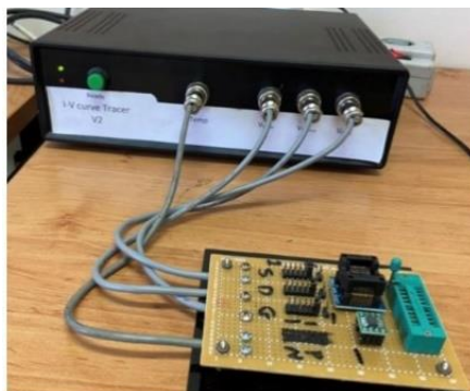
شکل (۲) نمای ظاهری دستگاه رسام منحنی جریان- ولتاژ ترانزیستورهای ماسفت
