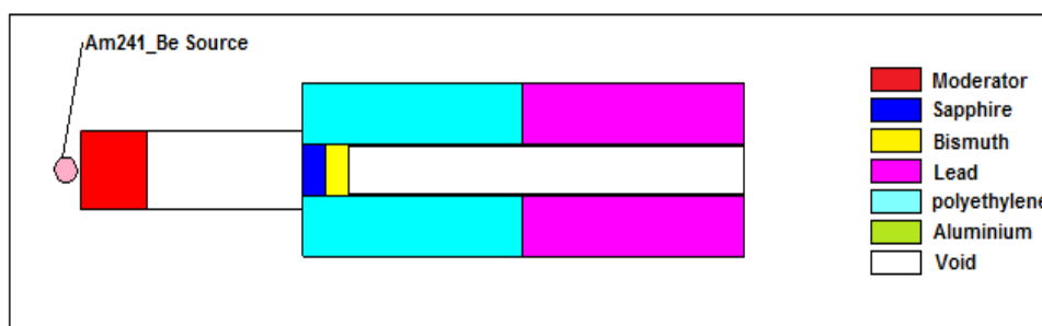
شکل ۱: ساختار یک کولیماتور نوترون با فیلترهای مربوط، شبیه‌سازی با کد MCNP ۶ .
