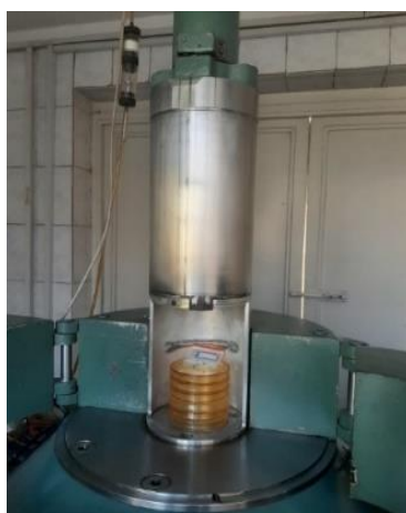
شکل (۴) قرارگیری نمونه‌ها تحت پرتودهی تابش گاما و استفاده از تضعیف کننده‌ها
