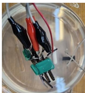
شکل ۵: ستاپ آزمایشگاهی اندازه‌گیری مقاومت الکتریکی
