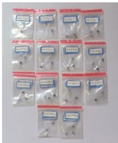
شکل (۳) آماده‌سازی نمونه‌های ترانزیستور ماسفت BS170 جهت پرتودهی
