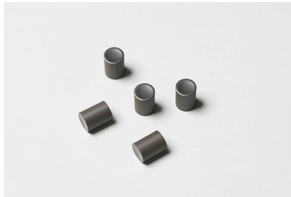
شکل (۴): نمای قرص سوخت راکتور PWR
