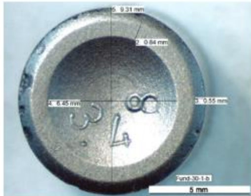
شکل (۳): نمای قرص سوخت راکتور VVER
