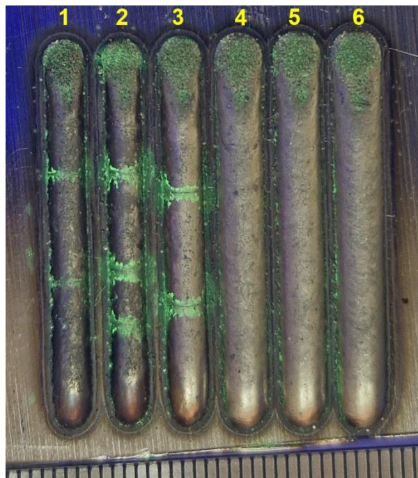
شکل ۳: تست مایع نافذ فلورسنت روکش کاری لیزری Colmonoy ۶ به صورت تک پاس ترتیب بر اساس جدول ۳
