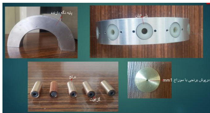
شکل ۲: اجزای تشکیل دهنده فنجان فارادی و پایه نگه دارنده.
