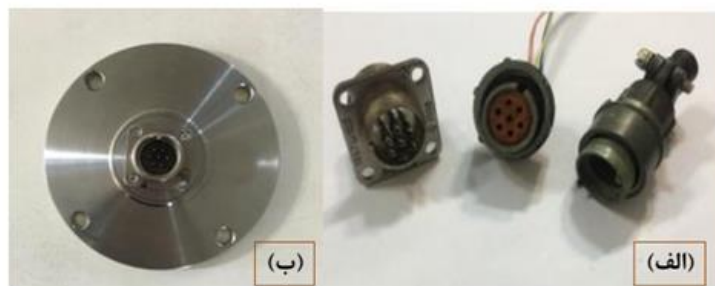
شکل ۵: (الف) تصویری از کانکتور خلاء بکاررفته در طیف‌سنج (ب) نمونه ساخته شده از پورت خروجی.
