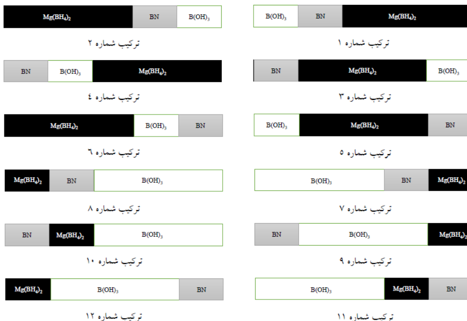
شکل (۳) پیکربندی حفاظ، به‌طوری که لایه‌ی سمت چپ نزدیک‌ترین لایه به چشمه است
