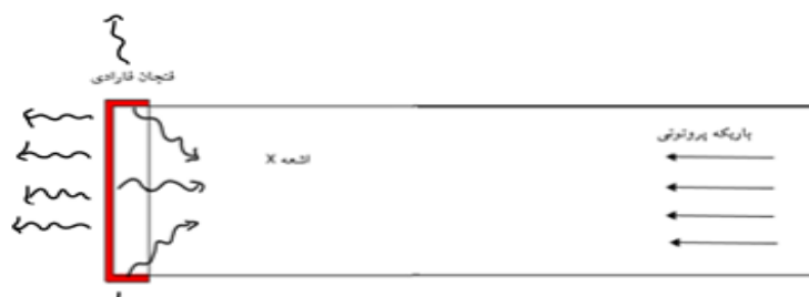
شکل (۱) چیدمان اندازه‌گیری جریان، شامل، استوانه انتقال دهنده باریکه و فنجان فارادی.
