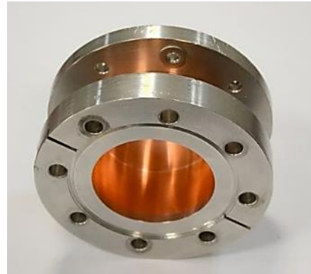
شکل ۱۲. نمونه‌ای از جوش نفوذی مس به فولاد زنگ نزن در شرایط بهینه جوش نفوذی برای انجام آزمون نشتی.
