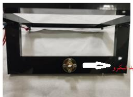
شکل ۲: لید اسکرو و پیچ متری استفاده‌شده برای حرکت دادن سیم
