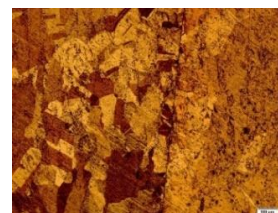
شکل ۵. تصاویر میکروسکوپ نوری از مشخصات ریزساختاری در سراسر اتصال و نفوذ در جوش نفوذی مس
