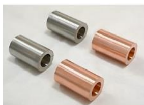
شکل ۴. نمونه AISI ۳۱۶L و نمونه مس خالص مائین‌کاری شده برای جوش نفوذی.
