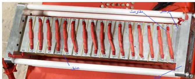
شکل (۵): موجبر ایزوله کننده ولتاژ چند لایه ساخته شده
