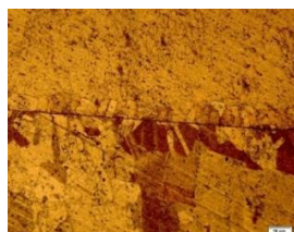
شکل ۵. تصاویر میکروسکوپ نوری از مشخصات ریزساختاری در سراسر اتصال و نفوذ در جوش نفوذی مس
