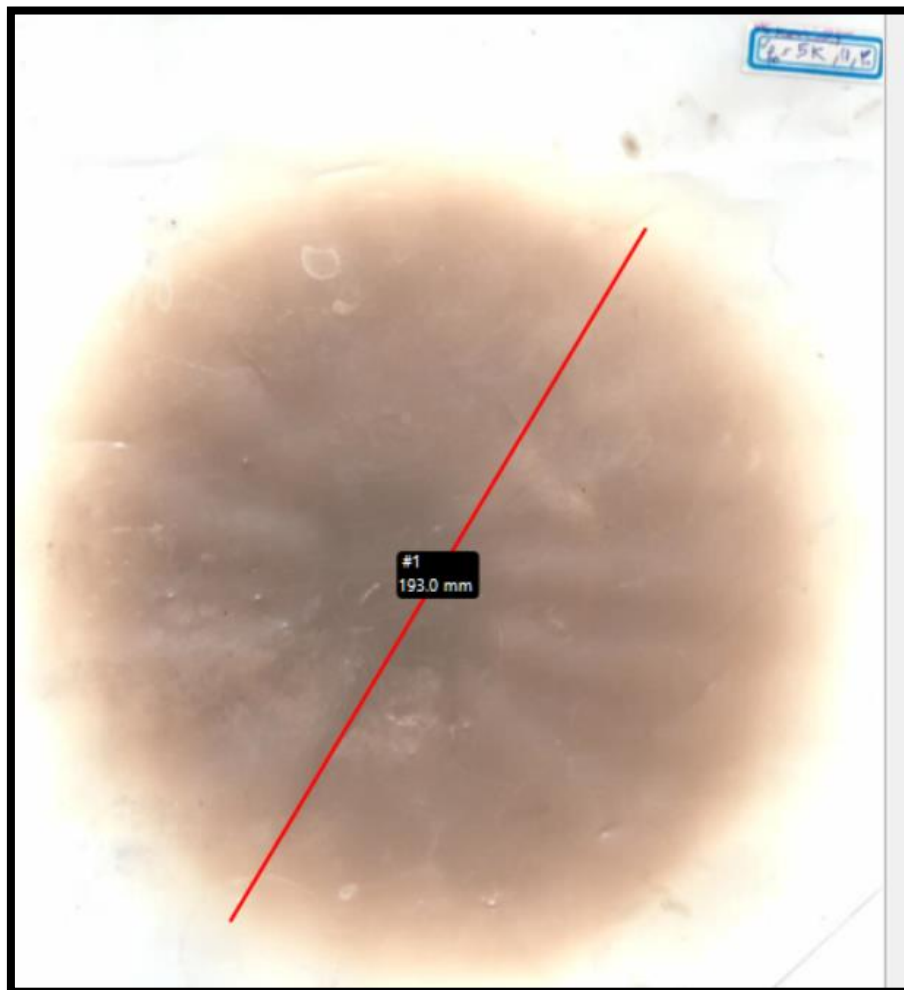
شکل ۷) نقش باریکه بر روی مایلار به ازای ولتاژ تمرکز ۵ کیلوولت
