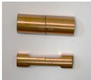
شکل ۱۰. نمونه آزمون کشش از اتصالات جوشکاری نفوذی در شرایط بهینه به دست آمده.
