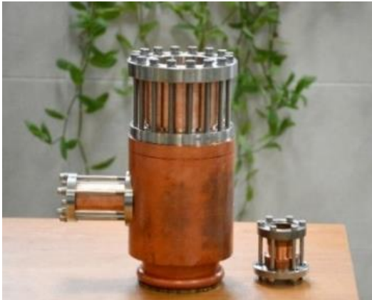
شکل ۱۳. فلنج و نمونه جوش نفوذی هم‌جنس و غیر هم‌جنس.
