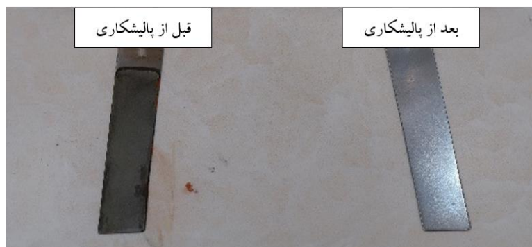
شکل ۲. نمونه‌های فولاد SA 179 برای انجام آزمونهای الکتروشیمیایی.
