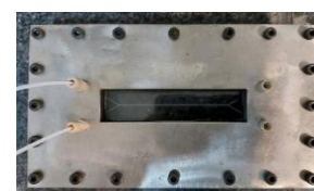
شکل (۱): تصویر میکروکانال ساخته شده و سیستم آزمایشگاهی استفاده شده برای جداسازی ایزوتوپی لیتیم
