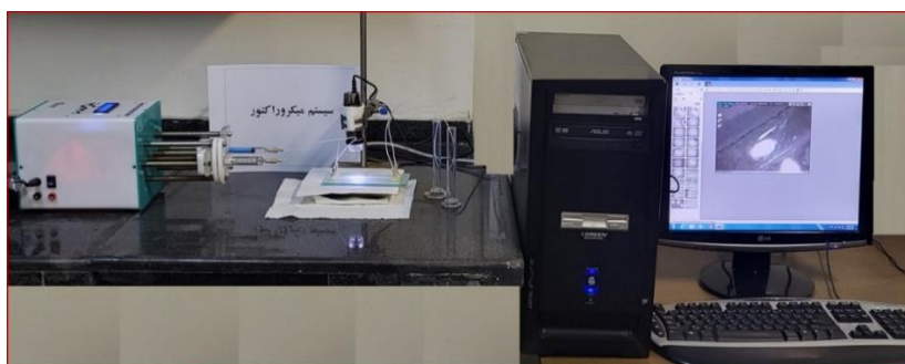
شکل (۱): تصویر میکروکانال ساخته شده و سیستم آزمایشگاهی استفاده شده برای جداسازی ایزوتوپی لیتیم
