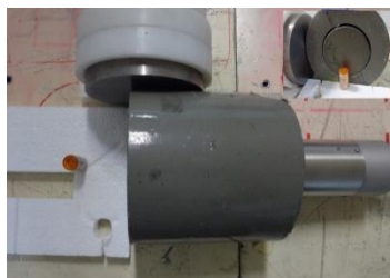
شکل (۱) چیدمان هندسه ثبت طیف تجربی چشمه‌های رادیوایزوتوپی مختلف ^{241}Am , ^{152}Eu , ^{22}Na و ^{137}Cs با اکتیویته حدود 1\text{ }\mu\text{Ci} برای آشکارساز (3\times3\text{ BGO}(\emptyset)
